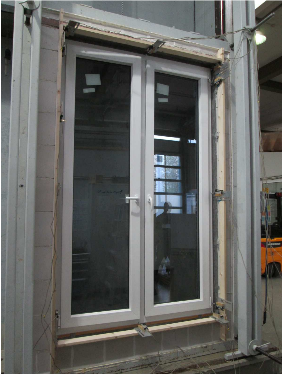
Bild 11 Ansicht Probekörper mit angebrachten Messstellen
